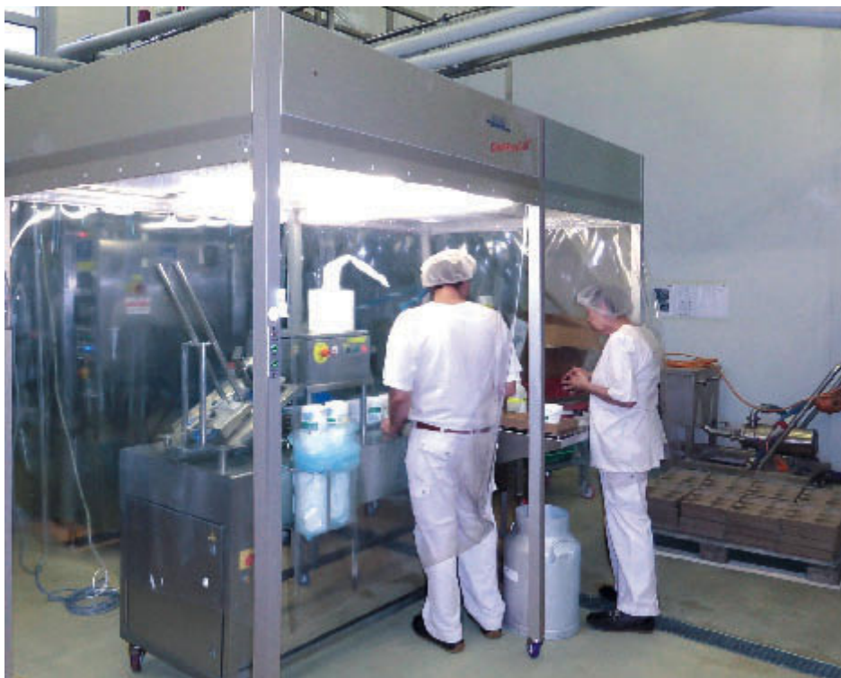
Abfüllprozeß Biojoghurt: Die Laminarfloweinhausung CleanFlowCell der Reinraumklasse ISO-7 ist fahrbar und kann flexibel und ortsunabhängig eingesetzt werden
