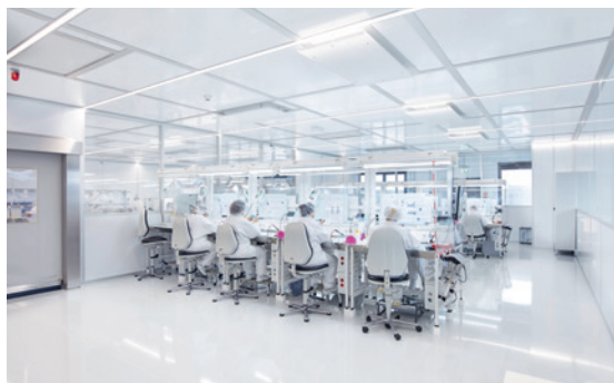
Ein Raum-in-Raum-Reinraumkonzept für die Stent-Herstellung der Firma Artivion
